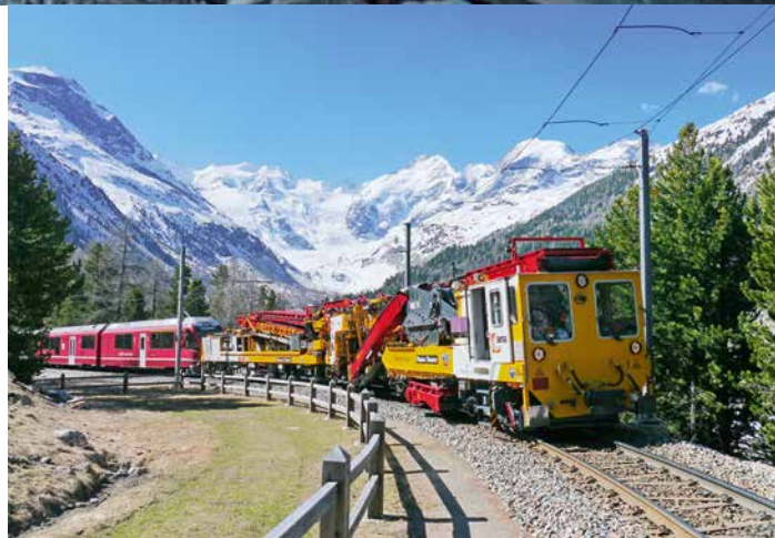
Transfert vers la ligne de la Bernina: machine de nettoyage de ballast Capricorn RM 76.
