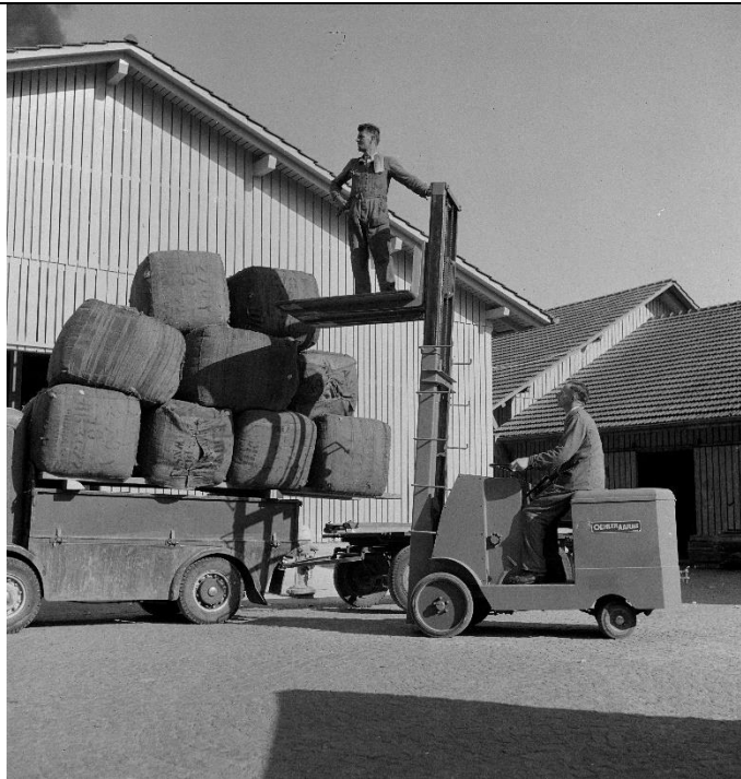
Demonstration eines elektrischen Zinkenhochstaplers von Oehler (VA-3425).
