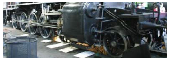
Stangenantrieb bei Dampflok C 5/6 „Elefant, Schlepptender Güterzug- lokomotive, 1916
