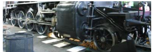
Stangenantrieb bei Dampflok C 5/6 „Elefant, Schlepptender Güterzugslokomotive, 1916
