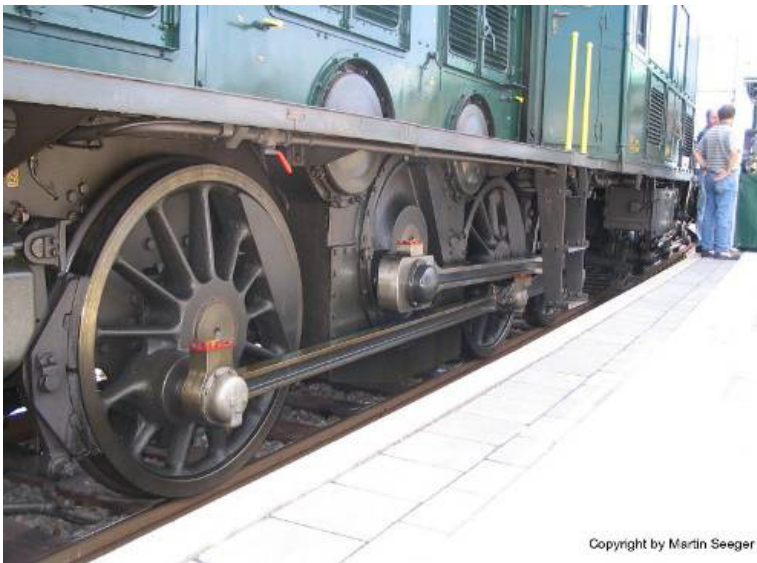
Stangenantrieb bei Elektrolokomotive Be 6/8 „Krokodil“
